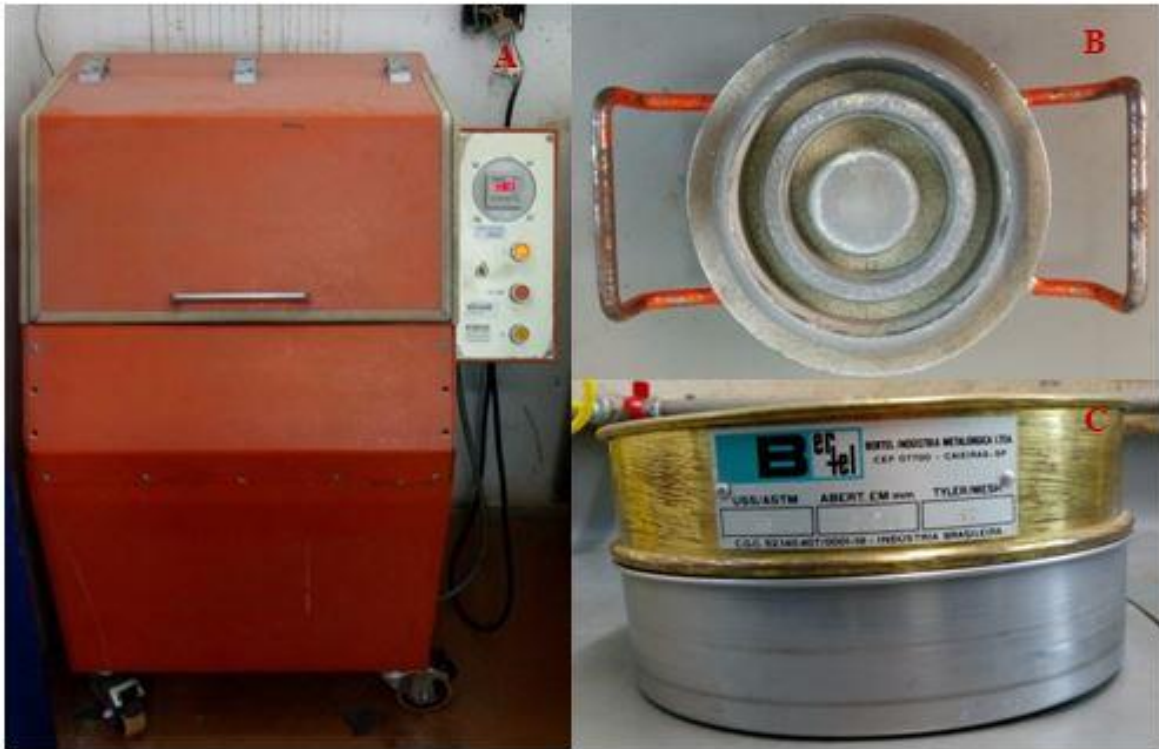
Após a 4ª Etapa (quarteamento), foi feita a 5ª Etapa: Moagem das duas amostras ZC e BZ. A) Moinho, B) Panela de tungstênio, C) Peneira de 32 Mesh.
