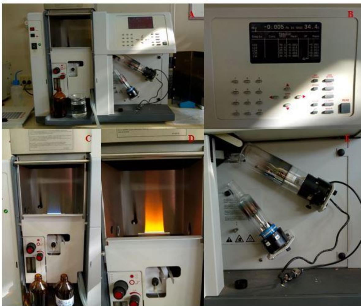
A) Equipamento de espectrometria atômica; B) Painel de controle e visualização dos dados; C) Detalhe da cor natural da chama azul; D) Detalhe da cor da chama laranja quando queima a solução contaminante, a cor laranja indica presença de sódio na solução contaminante, o sódio é oriundo das relações de troca catiônica que ocorrem entre a solução e a zeólita; E) Detalhe da lâmpada que emite uma onda com frequência específica para a detecção do chumbo.
