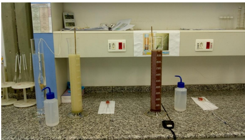
Etapas do ensaio granulométrico e da densidade de partículas: A) Pesagem, B) Agitação por 24 horas, C) Sedimentação para determinação dos finos.
