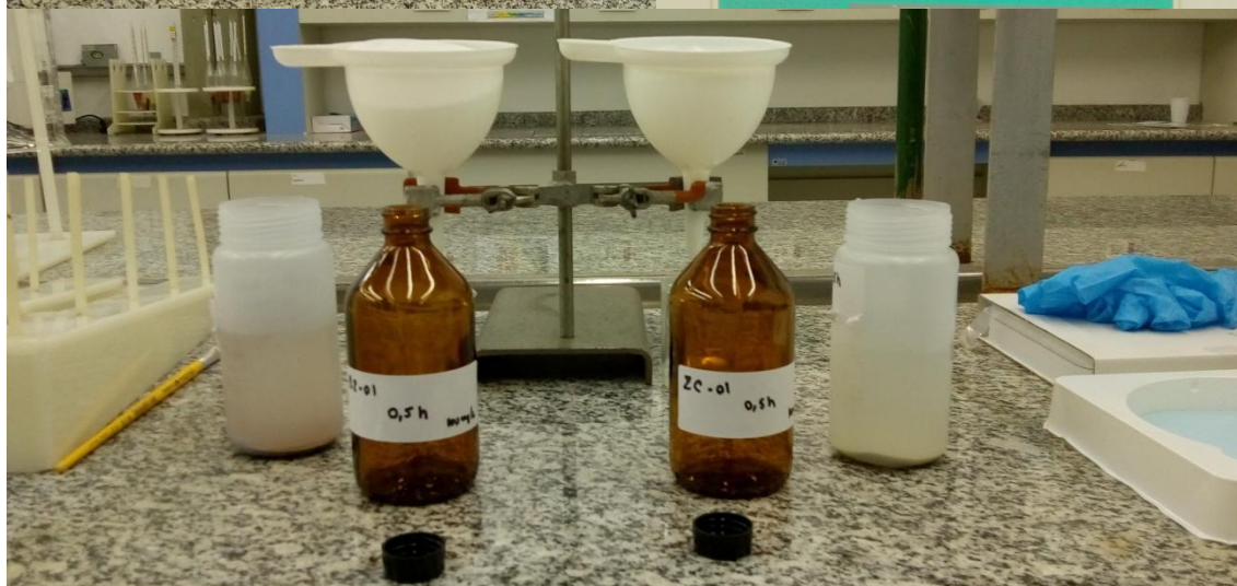
Etapas dos ensaios de adsorção em lote: A) Medição do pH, B) Mesa agitadora, C) Centrifuga e D) Filtragem.
