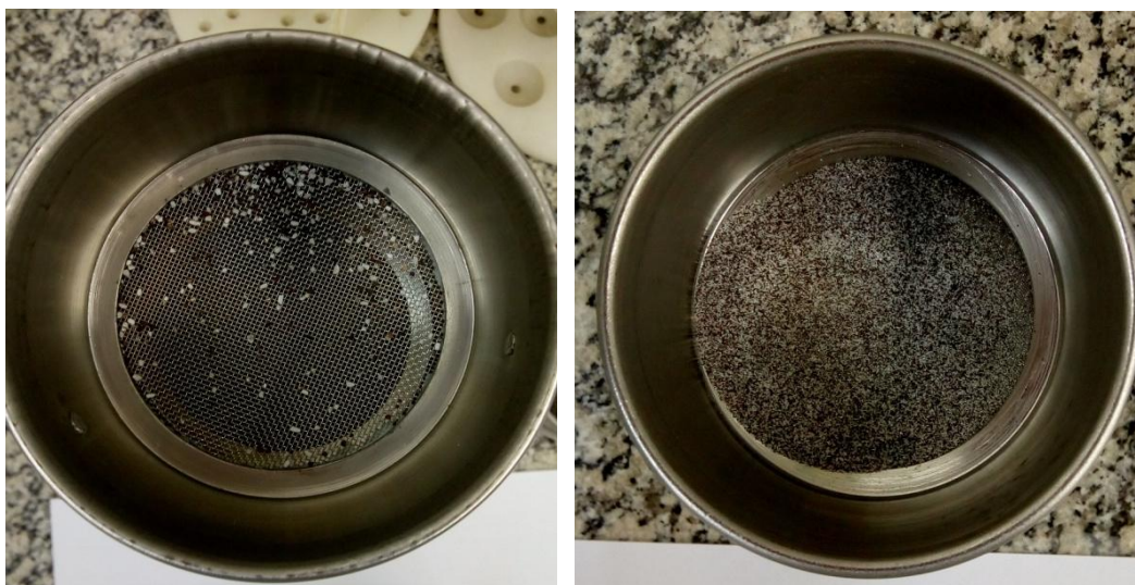
Peneiramento para determinação da fração grossa: A) Lavagem para eliminação da porção fina: B) Eliminação da matéria orgânica e C) Peneiramento.
