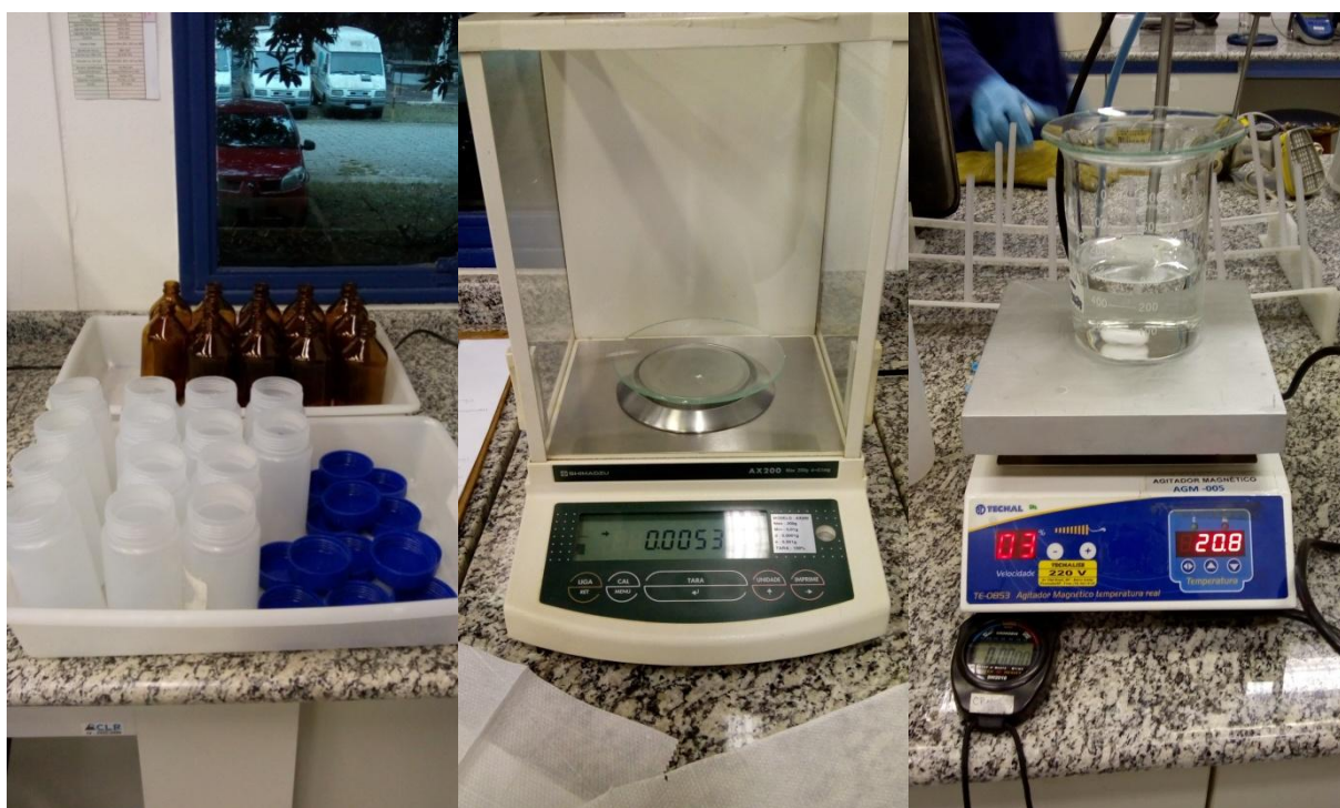
Etapas do ensaio de adsorção em lote, da direita para a esquerda: Frascaria usada nos ensaios de adsorção, Pesagem do contaminante e agitação magnética.
